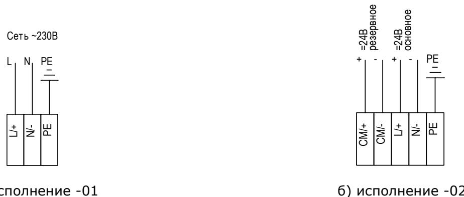
**Рисунок 5 – Схема подключения питания**
