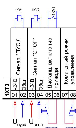
5. Для управления шкафом от внешних сигналов управления (1XT1:1 - 1XT1:8), переключатель режима работы шкафа на передней панели должен быть установлен в положение "A".
