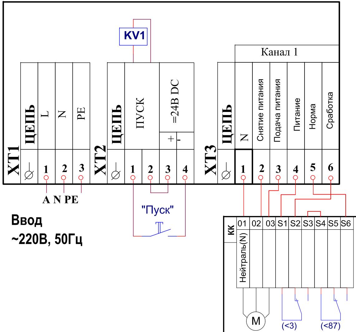
Пример подключения на канал №1 клапана с электромеханическим реверсивным приводом "Belimo" ~220В:
