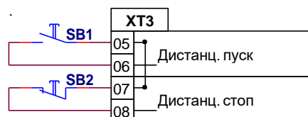
Рисунок 6 – схема подключения кнопок дистанционного пуска и сброса.
