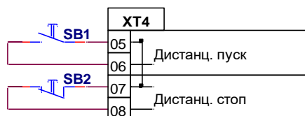
Рисунок 6 – схема подключения кнопок дистанционного пуска и сброса.
