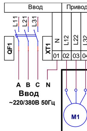
Подключение цепей команд управления и цепей выходных сигналов к установленному в шкафу блоку БУЭП-1 выполнить в соответствии со схемой слева применительно к необходимому алгоритму работы.
