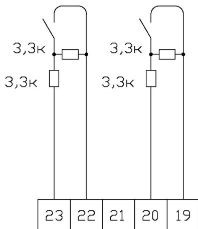
*Управление одним постоянным сигналом сухим контактом*
