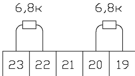
*Управление одним постоянным сигналом напряжением*
