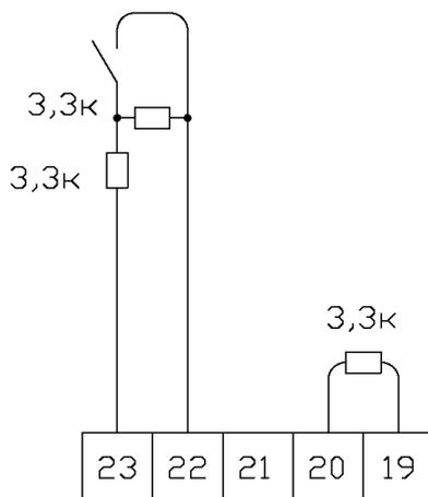
*Управление двумя отдельными сигналами напряжением*
